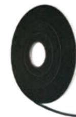
Cinta de doble cara de espuma de PE, de 3mm de espesor y 12 mm de ancho. Regula la distancia entre el perfil y el panel para asegurar el correcto espesor en el sistema.
