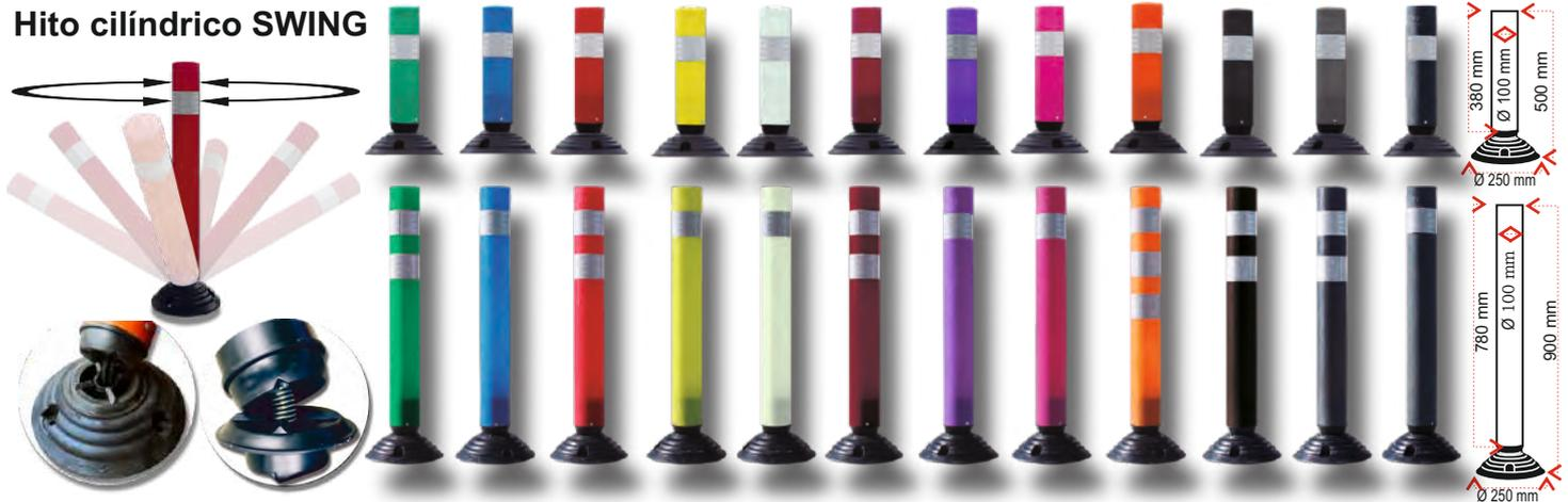
Pensadas para anclar la base al asfalto o superficie, y poder colocar y quitar la baliza de dicha base sin necesidad de desatornillado del anclaje, el hito Swing además está fabricado con un modulo elástico intermedio entre la base y la baliza que le permite desplazarse en ángulos hasta 360°, si un vehículo los golpea.
