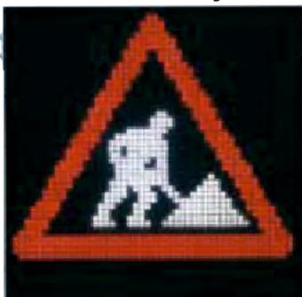
Panel de mensaje variable para gráficos de 970 mm x 970 mm, fabricado con tecnología SMD Full Matrix con Leds de color rojo y blanco. Muestra el texto de forma continua, sin intermitencias, y cuando se desconecta queda totalmente en color negro.
