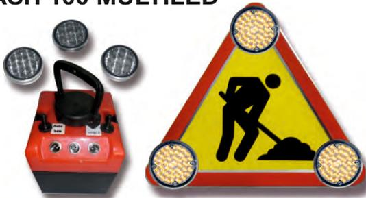
Cada foco tiene unos insertos de rosca hembra M-4 para facilitar su fijación sobre cualquier soporte. Con interruptor crepuscular ON/OFF y célula fotoeléctrica para encendido y apagado automático, modo sólo noche, y selector para funcionamiento 24 horas en modo día y noche. Presenta dos modos de funcionamiento, la función secuencial, y el modo triflash, con accionamiento de todos los focos simultáneamente.
