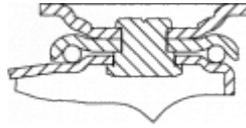
Soporte embutido con chapa de acero hasta 2 mm de espesor.
