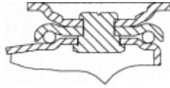
Soporte embutido con chapa de acero hasta 2 mm de espesor. Acabado cincado brillante. Soporte con rodamiento de bolas. Fabricadas según normas europeas EN 12528.
