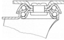
Fabricada con chapa de acero hasta 2 m/m de espesor. Soporte con doble rodamiento a bolas. Acabado cincado. Fabricadas según normas europeas EN 12528.
