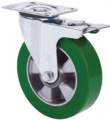
Ruedas con núcleo de aluminio y banda de rodadura en forma balona de poliuretano verde de dureza 80° shoreA. Especialmente indicada para soportar cargas hasta 700 Kg.
