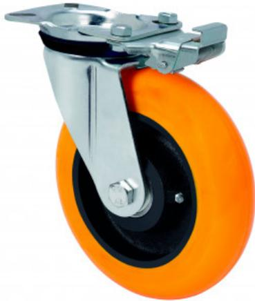
Ruedas con núcleo de acero y banda de poliuretano fundido con dureza de 95° shore A, con banda de rodadura en forma balona, especialmente indicada para soportar altas cargas hasta 700 Kg.
