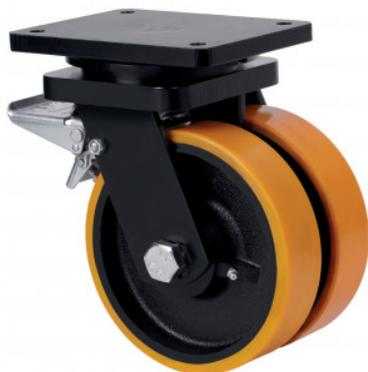
Rueda doble con núcleo de acero y banda de poliuretano fundido con dureza de 95° shoreA, especialmente indicada para soportar altas cargas de hasta 2.500 Kg.
