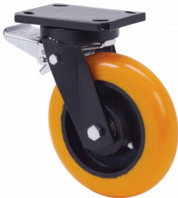
Ruedas con núcleo de acero y banda de poliuretano fundido con dureza de 95° shore A con banda de rodadura en forma balona, especialmente indicada para soportar altas cargas hasta 800 Kg.
