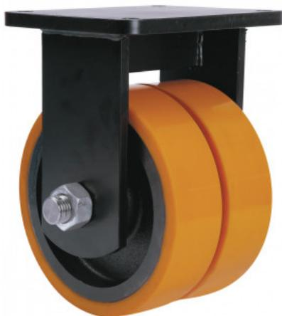
Rueda doble con núcleo de acero y banda de poliuretano fundido con dureza de 95° shoreA, especialmente indicada para soportar altas cargas hasta 4.000Kg.
