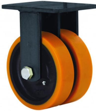
Rueda doble con núcleo de acero y banda de poliuretano fundido con dureza de 95° shoreA, especialmente indicada para soportar altas cargas de hasta 2.500 Kg.
