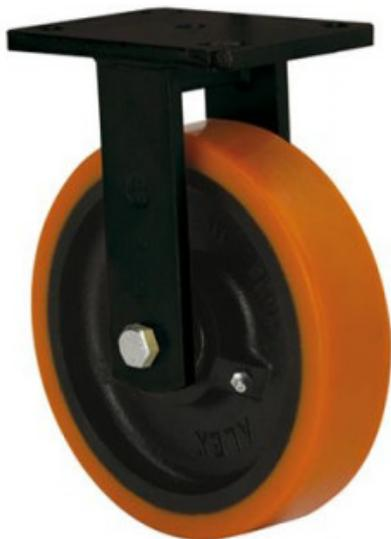
Ruedas con núcleo de acero y banda de poliuretano fundido con dureza de 95° shore A, especialmente indicada para soportar altas cargas hasta 1.900 Kg.
