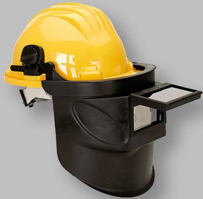
El cuerpo de la pantalla va provisto de una cavidad rectangular para alojar el ocular filtrante, éste consiste en un filtro inactínico abatible con dimensiones disponibles 110x55, 105x50 y 108x51. La pantalla posee además un cubrefiltro exterior de policarbonato incoloro de 1 mm de espesor, cuya función es la de proteger el filtro inactínico contra proyecciones e impactos.
