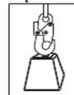
La capacidad máxima de carga del dispositivo anticaídas retráctil es de 150 kg.
