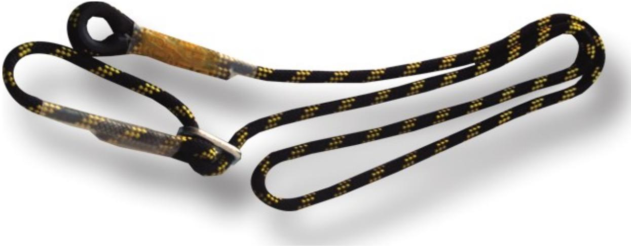
Elemento de amarre o posicionamiento de poliamida trenzadas de 12 mm dotada de “ojales” con protección antiabrasión y una anilla metálica que permite la regulación de su longitud hasta 1,8 mt.
